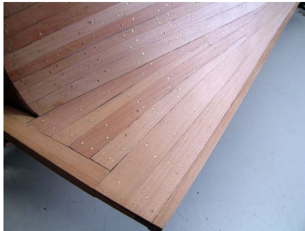
Fig. 12.5 – En este modelo de La Belle de 1684 se puede apreciar cómo dos tracas corren a popa sin alefriz en el codaste. (Modelo de C. Hormaechea) 17
