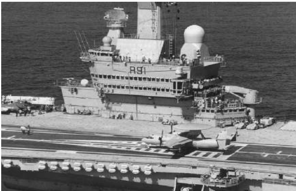
Vista de la isla del Charles de Gaulle , por la aleta de babor, donde destaca el Primario de vuelo y en la catapulta de babor un avión de descubierta avanzada Grumman Hawkeye.
